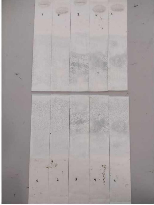
Fotoğraf 5 Başarısızlık modu soyulma direnci, termal eskitme sonrası
