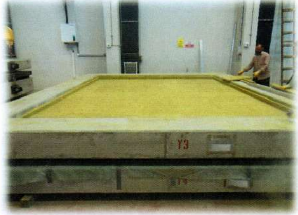
ii)30/150 Terrawool yerleşimi tamamlanmış
